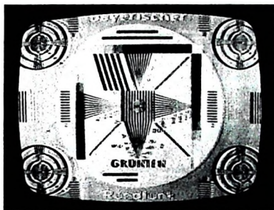
Bild 1. „Geisterbild“ infolge Reflexion des Senderstrahls an einem Hindernis
