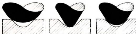
Abtastnadel berührt auf Rillenflanke (falsch) Abtastnadel berührt auf dem Rillengrund (falsch) Abtastnadel berührt die Mitte der Rillenflanke (richtig)
