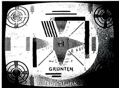
Bild 2. Störungen auf dem Bildschirm, hervorgerufen durch Zündkerzenfunken
